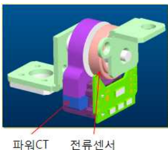
그림 4. Power-CT와 전류 센서 구조도 Fig. 4. Structure of power-CT & current sensor
