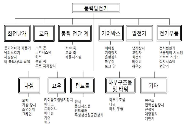
그림 2. 풍력발전기의 세부 구성 Fig. 2. Subassemblies of wind turbine[4]
