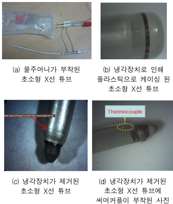
그림 1. 온도 측정을 위해 사용한 초소형 X선 튜브 Fig. 1. A miniature x-ray tube for temperature measurement.
