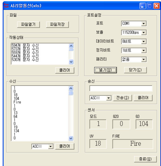
(그림 10-3) (UV+IR)모드-1 영상검출(G3:104) (Fig.10-3) Result of UV+IR(mode-1) Detection (G3:104)
