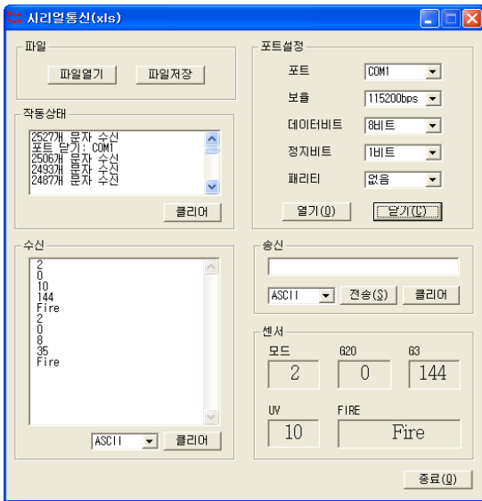
(그림 10-2) (UV)모드-2 영상검출(G3:144)결과 (Fig.10-2) Result of UV(mode-2) Detection (G3:144)
