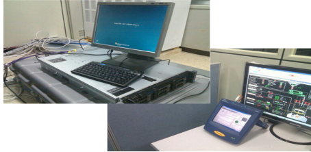
그림 11 주요 시험장치 : 트래픽 분석장치(좌), 트래픽 발생장치(우) Fig. 11 Test equipment : traffic analyzer(left), traffic generator(right)
