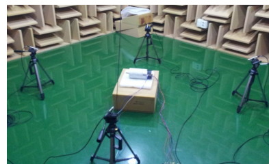
그림 10 제작된 SRM의 소음 측정 Fig. 10 Measurement of acoustic noises
