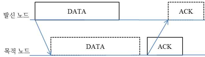
그림 3. 제안된 MAC 프로토콜의 기본 전송주기 Fig. 3. Basic transmission period of proposed MAC protocol.
