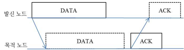
그림 1. Pure ALOHA의 전송 주기 Fig. 1. Transmission period of pure ALOHA scheme.
