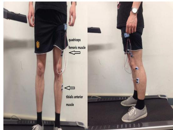
그림 1. 근전 신호 측정을 위한 전극 부착 위치
