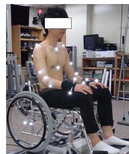
그림 1. 3차원 동작분석 시스템을 위한 마커 부착
