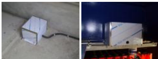
Fig. 11 구조물 가속도계(좌) / TMD 가속도계(우) 설치 사진
