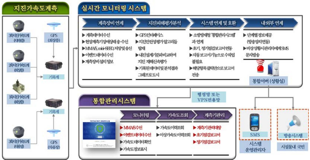
Fig. 3 지진가속도계측기 시스템 구성 (건축물의 경우)
