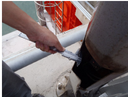
(b) 설치되어 있는 가로등주 실측 두께 (t=2.5mm) 도면(t=3.2mm)과 상이
