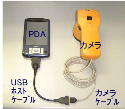
Fig. 7 균열 측정 기구
