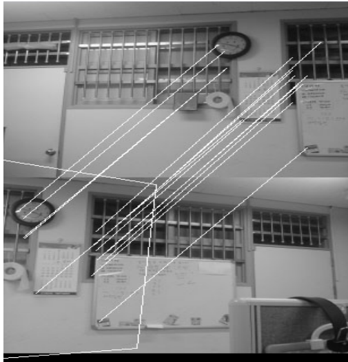
그림 8. SURF 알고리즘을 적용한 결과 Fig. 8. Result of applying SURF Algorithm
