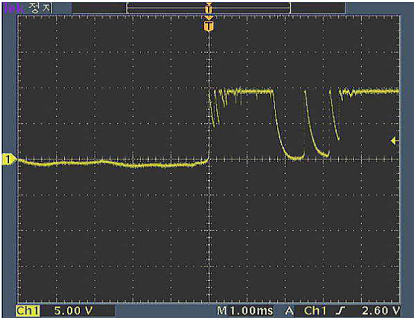
그림 7. 면적변화에 따른 바운싱현상(자속 11.4 \mu wb) Fig. 7. The bouncing phenomenon according to area change(Magnetic flux 11.4 \mu wb)
