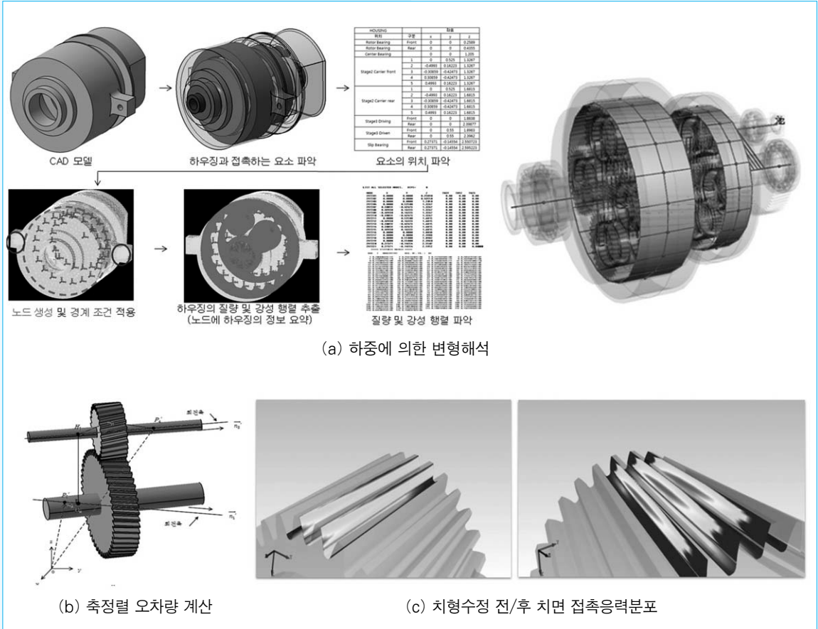
그림 12 케이스 변형을 고려한 풍력발전기용 기어박스 치형수정
