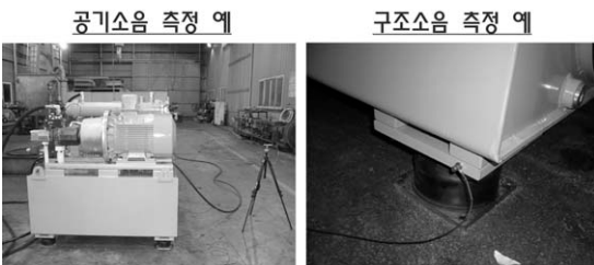
그림 2 탑재장비 공기소음 및 구조소음 측정 예
