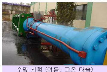
<그림 1> Life test of extra-large hydraulic cylinder for sluice gates
