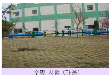
<그림 1> Life test of extra-large hydraulic cylinder for sluice gates
