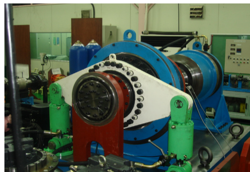
<그림 9> Picture of a normal-opposite rotational shock torque generator using a hydraulic cylinder
