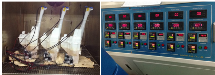
<그림 5> 워셔펌프 작동내구 특성 분석 시험 장치
