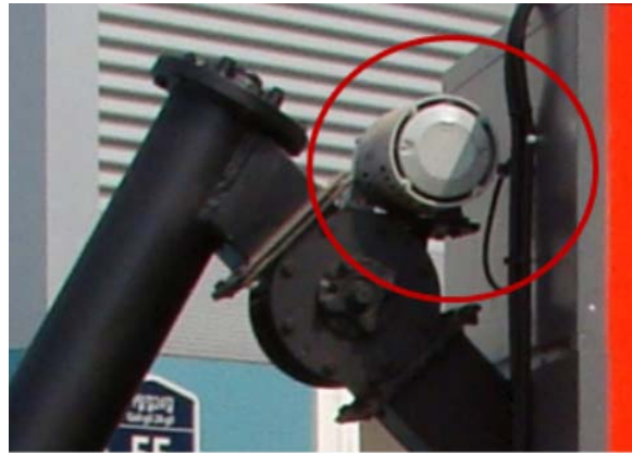
<그림 8> 연료투입구의 에어커튼에 의한 2차 역화방지를 위한 송풍기
