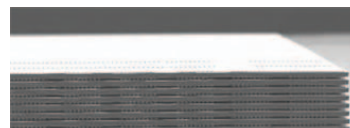
<그림 15> DRAM이 적층된 후 TSV를 통해 연결된 제품 (출처 : SK하이닉스)
