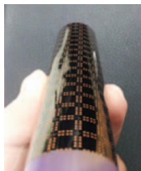
〈그림 17〉 하나마이크론의 플렉시블 패키지 기술로 개발한 전자 소자
