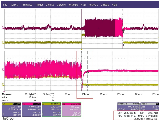
그림 15. 송수신 스위칭에 따른 설정시간 (수신 설정) Fig. 15. Delay for switching from transmission to reception
