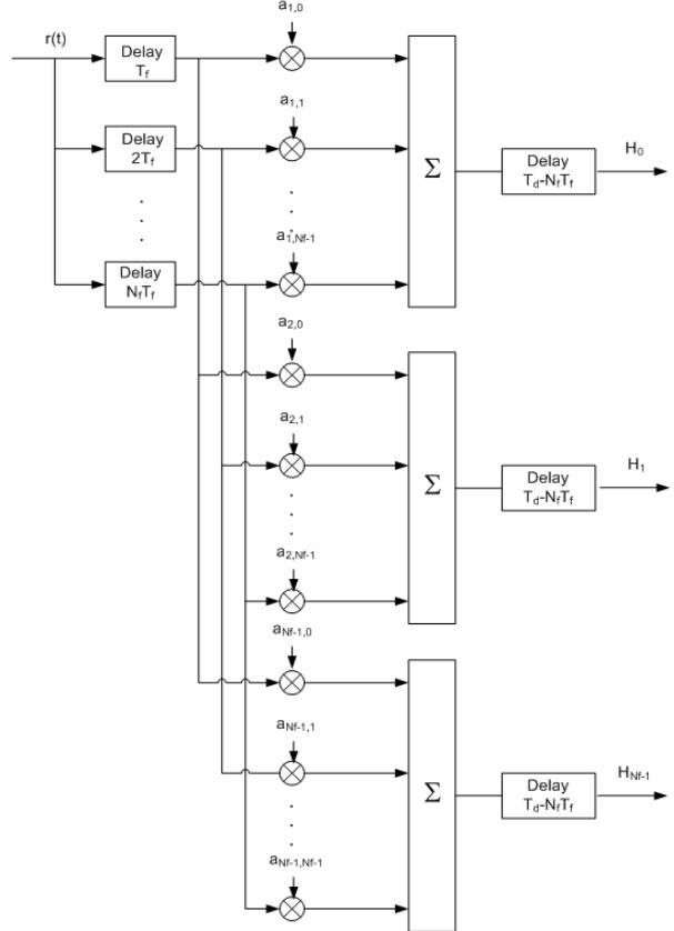
그림 4. 제안하는 TR-BCM 방식에서의 기준틀 발생기 (Template Generator) 구조
