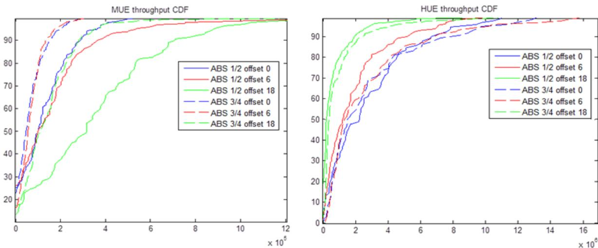
그림 10. ABS의 주기(1/4, 1/2) 및 CRE offset에 따른 매크로 셀(좌)과 피코 셀(우)의 사용자 수율[bps]
