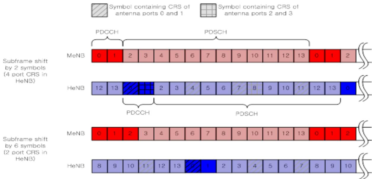
그림 4. 매크로 셀 기지국과 홈 기지국의 OFDM 심볼 쉬프트의 예
