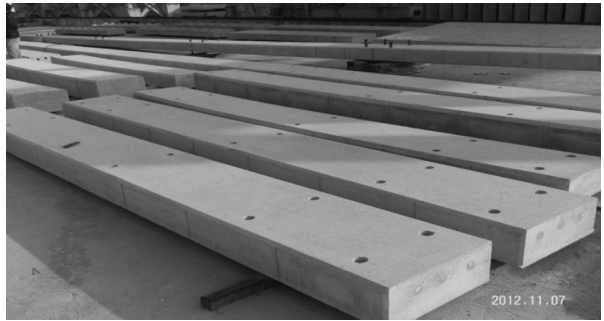
그림 10. 프리캐스트형으로 제작된 주행로 패널
