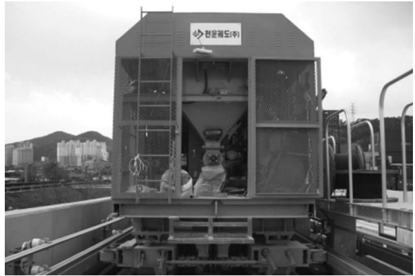
그림 8. 연마차를 이용한 주행면 평삭
