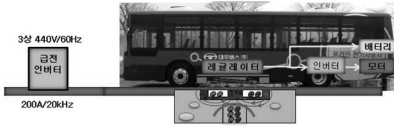
그림 2. 온라인 전기자동차급·집전시스템 개념도
