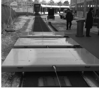
그림 9. 무가선트램 적용을 위한 무선전력전송 급전선로 및 픽업 구성
