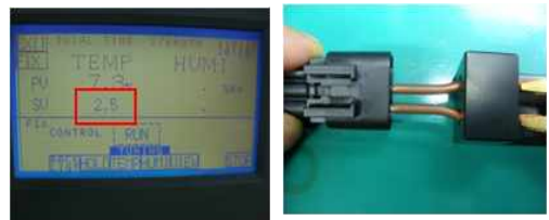
그림 17. 바이메탈 통과저항 측정 Fig 17. Bimetal's resistor measurement
