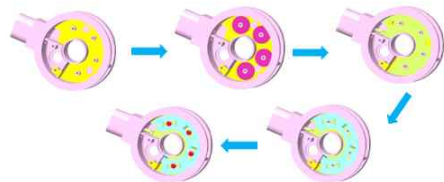
그림 13. 통합히터의 바디내 체결과정 Fig 13. Body assembly process of heater
