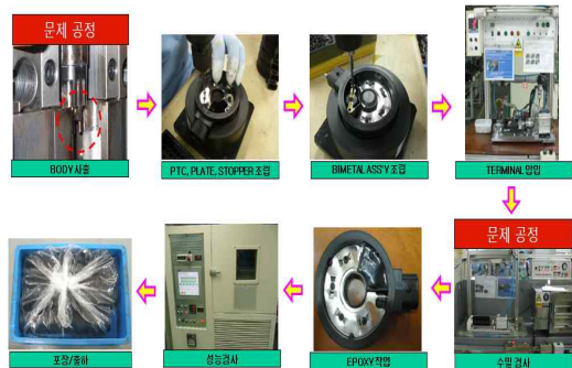
그림 16. 히터 제작 흐름도 Fig 16. Heater assembly flow
