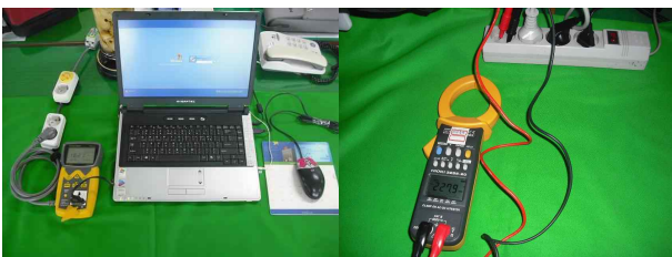
[Fig. 1] Standby power Meter
