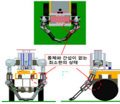
그림 4. 바닥 작업이 가능한 로봇 팔 Fig. 4. Robot arm suitable for floor tasks.
