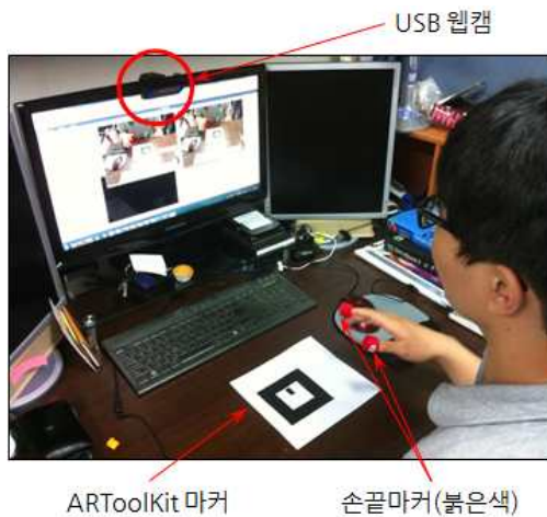
그림 3. 손 재활운동을 위한 테이블-탑 증강현실 시스템 구성
