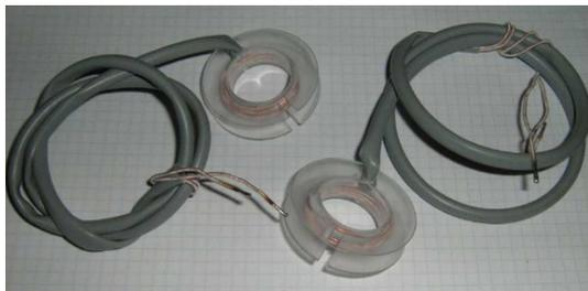
그림 12 시험 모의코일
