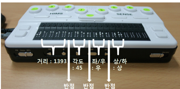
그림 5 한소네 포켓에 표시된 점자 정보 Fig. 5 Braille displayed on the Hansone pocket
