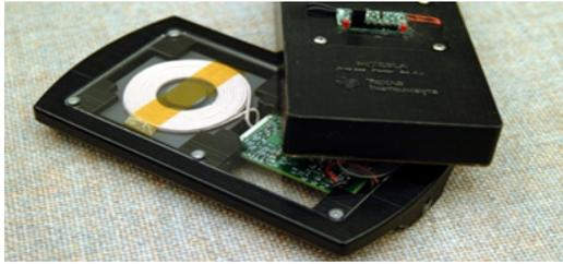
그림 2 TI의 새로운 무선전송 충전키트. 비접촉 방식을 사용한 제품.
