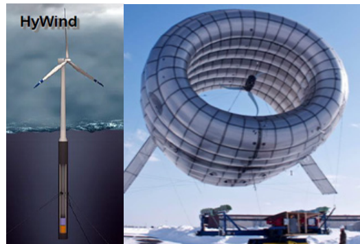
그림 13 노르웨이 Stat-oil사의 2.3MW 부유식 풍력 실증(2.3MW)과 미국 Altaeros사의 공중 부양식 풍력발전(206m 실증)
