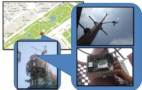
그림 8. 센서 노드 test bed 위치 및 설치도
