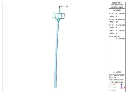
그림 12. 풍속 60 m/s일 때의 displacements
