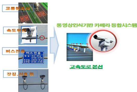
그림 6. 유료도로 본선 동영상인식기반 카메라 통합 시스템
