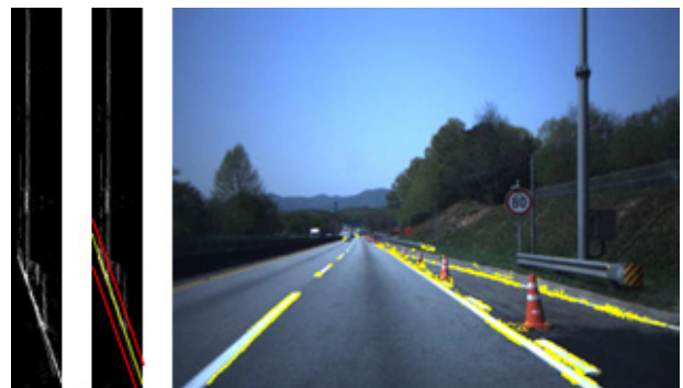
그림 6. VD지도 와 지면 추정, 원영상에서의 지면추정 (좌로부터) Fig. 6. VD map and ground estimation, ground estimation in the original image (from left).
