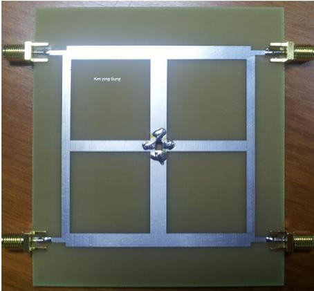
그림 5. 제안하는 브랜치 라인 커플러의 제작 사진
