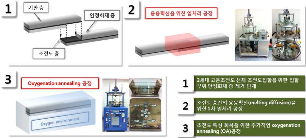
그림 11. 2세대 고온초전도 선재의 접합공정 절차 및 공정별 특수열처리로.
