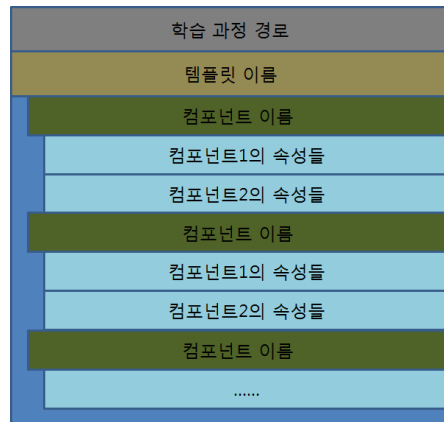
그림 5. 디스크립터 파일의 구조 Fig. 5. Architecture of descriptor file
