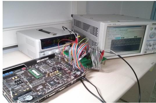
그림 7. 제작 칩의 테스트 시스템 Fig. 7 Test system for the fabricated chip
