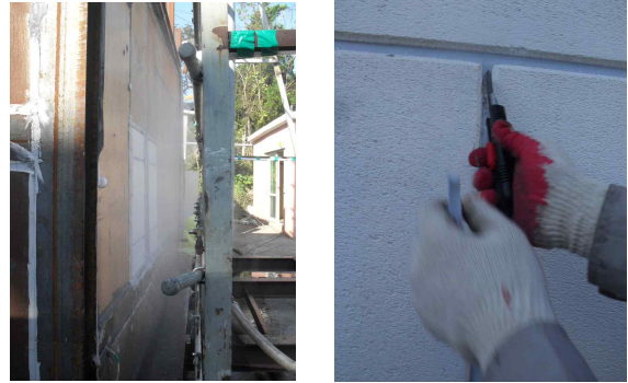
그림 4. 패널 간의 조인트 시험 전경 및 실러트
