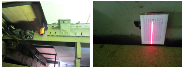
그림 11. 층간 변위용 가력장비 및 변위량 표시
