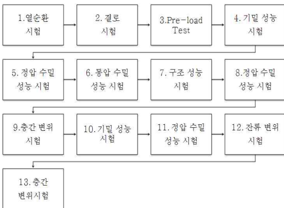
그림 2. ALC 외장 패널의 단계별 Mock-up Test 프로세스
