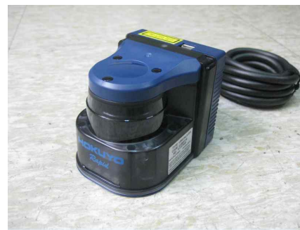
그림 5. 환경인식용 레이저파인더의 외형 Fig. 5. Laserscanner for environment recognition
