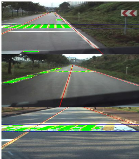
그림 14. 횡단보도 인식 결과 Fig. 14. Crosswalk detection results
