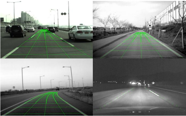
그림 10. 다양한 주행환경에서 검출된 차선 Fig. 10. Lane detection results in various road environments
