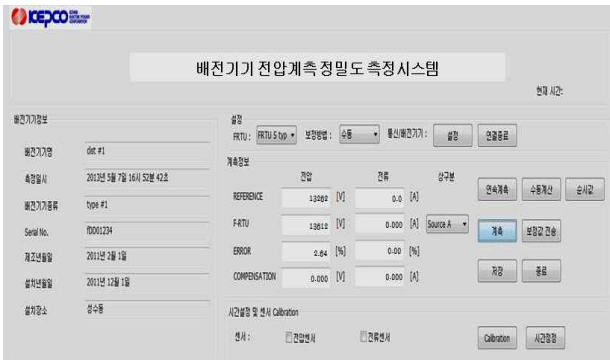
그림 8. 배전기기 전압계측 정밀도 평가시스템의 HMI Fig. 8. HMI of voltage measurement accuracy assessment system
