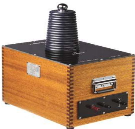
그림 2. 표준 변압기 Fig. 2. Standard voltage transformer
