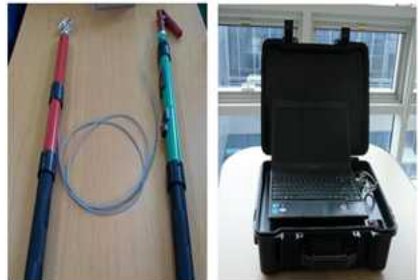
그림 5. 전압계측 정밀도 평가시스템 시작품 Fig. 5. Prototype of voltage measurement accuracy assessment system
