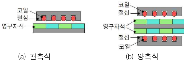
그림 3. 영구자석 선형 전동기의 구조 Fig. 3. Structure of PMLSM
