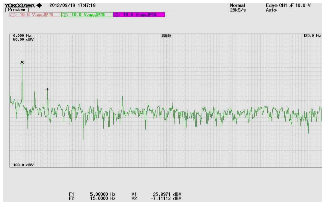
(b) 오실로스코프에 의한 a상 역기전력의 고조파 스펙트럼 (b) FFT spectrum analysis of a-phase back-EMF by oscilloscope
