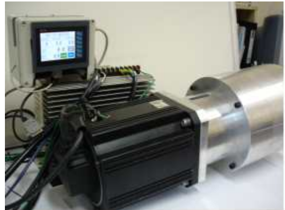
그림 3. 발전기 구동용 M-G 셋업 장치 Fig. 3. M-G setup apparatus for generator driving
