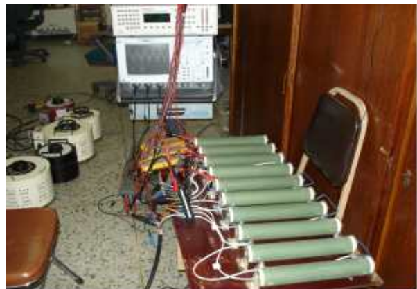
그림 4. 5상 발전기의 부하저항 Fig. 4. Resistive load for 5-phase SPMSG
