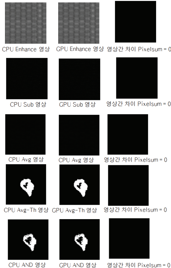
그림 12. GPU와 CPU의 구현 검증 실험 결과.
