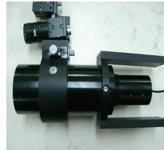
그림 3. 레이저와 카메라로 구성된 측정용 센서.
