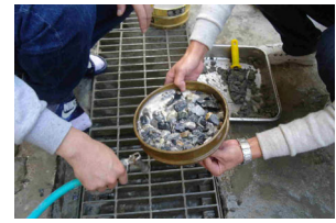
(d) Washing concrete
